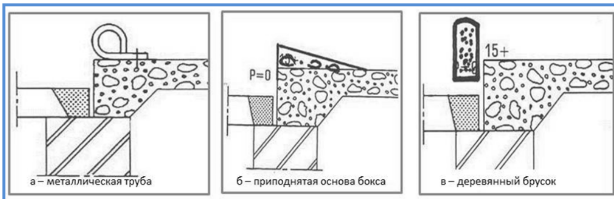
Рисунок 4.19 - Варианты технологических решений для сохранения в стойлах подстилки
