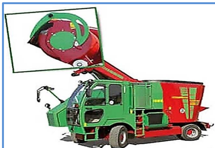
Рисунок 5.9 - Самоходный раздатчик с режущим щитом
