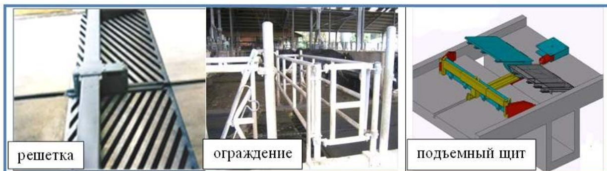
Рисунок 6.5 - Защита канала в месте прохода скрепера
