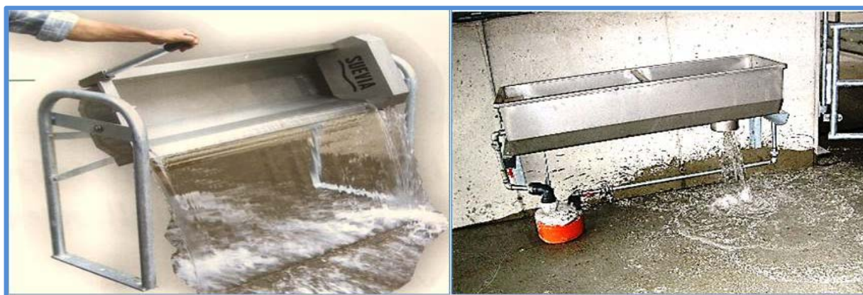
Рисунок 4.22 - Варианты промывки поилок
