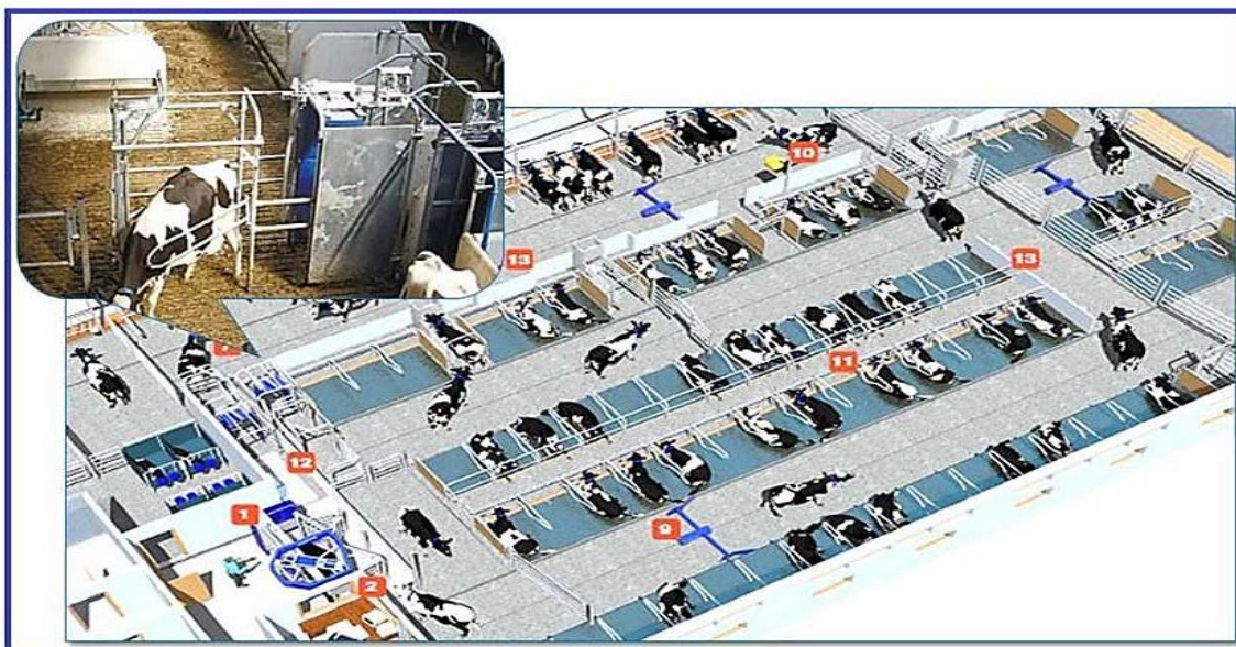
Рисунок 8.5 - Схема планировки коровника с системой добровольного доения VMS и воротами DeLaval SSG управляющими движением животных
