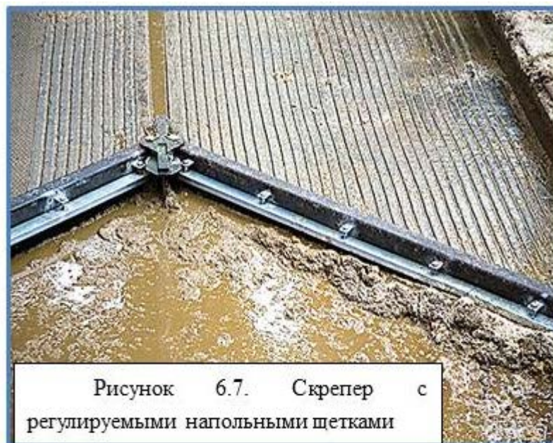
Рисунок 6.7 – Скрепер с регулируемыми щетками
