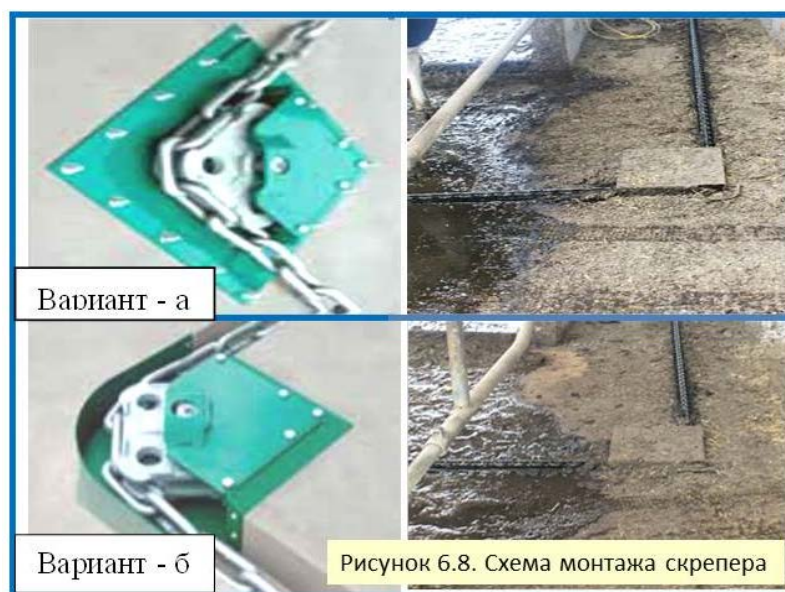
Рисунок 6.8 – Схема монтажа скрепера
