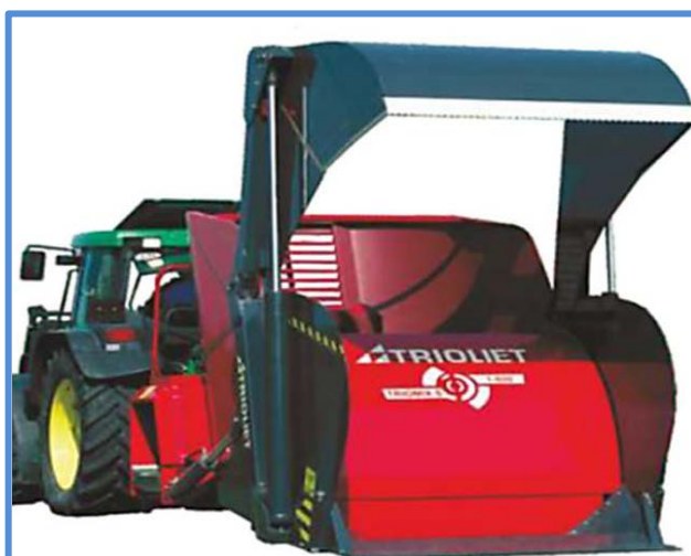
Рисунок 5.8 - Самозагружающийся раздатчик с механизмом загрузки ножом
