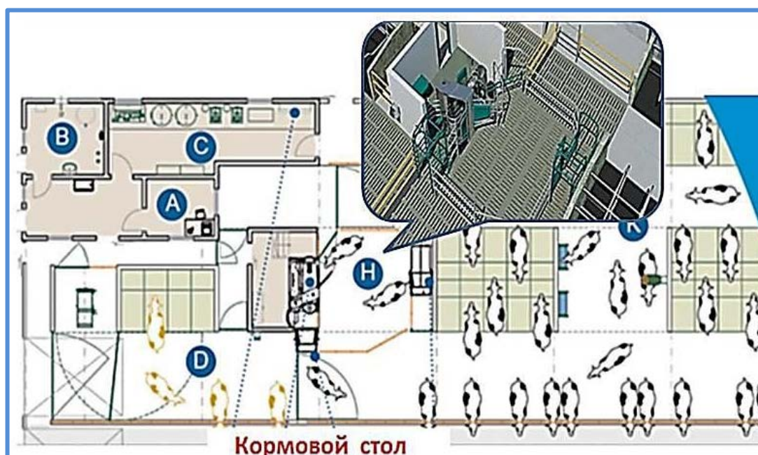
Рисунок 8.7 - Схема планировки коровника с доильным роботом Monobox управляемым движением животных на дойку.
